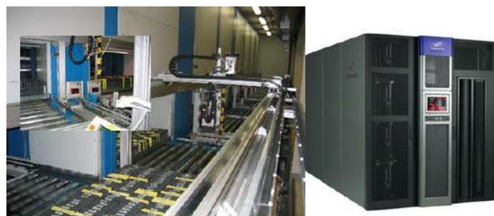
El antes y el después del almacenamiento de los materiales de archivo en ATRESMEDIA. La instalación robotizada, diseño exclusivo y único en el mundo con capacidad para 150.000 cintas, hoy prácticamente en desuso, y la actual librería digital principal con más de 6 petabytes de capacidad en cintas LTO-7
